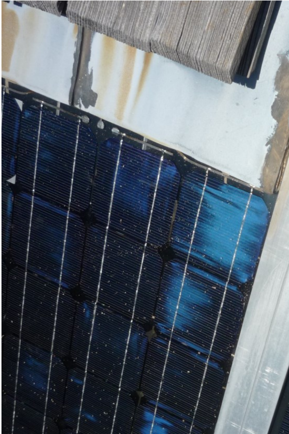
Abbildung 1: Alte PV-Anlage mit deutlicher Schädigung der PV-Zellen auf der gesamten Fläche
